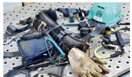
フルハーネス型安全帯は、高所作業時に使う命綱付きのベルトです。工具を取り付けると20kgになることも。
